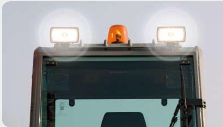
**Die Halogenstrahler** und die orange Rundumleuchte, die auf dem Dach des Fahrerhauses angebracht sind, garantieren auch während der Nachtstunden eine perfekte Sicht. Es können zusätzliche Halogenstrahler für die Arme und den Ballast angefordert werden, um die Sicht noch weiter zu verbessern.
