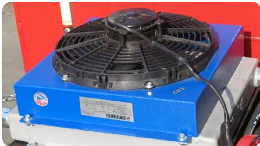
**Die Kühlung des Hydrauliköls** wird durch einen entsprechenden weitmaschigen Wärmetauscher aus Aluminium garantiert, der den Luftdurchgang auch unter staubigen Umgebungsbedingungen fördert und so Verstopfungen verhindert. Am Kühler ist ein elektrisches Gebläse angebracht, das für den Luftdurchgang sorgt.
