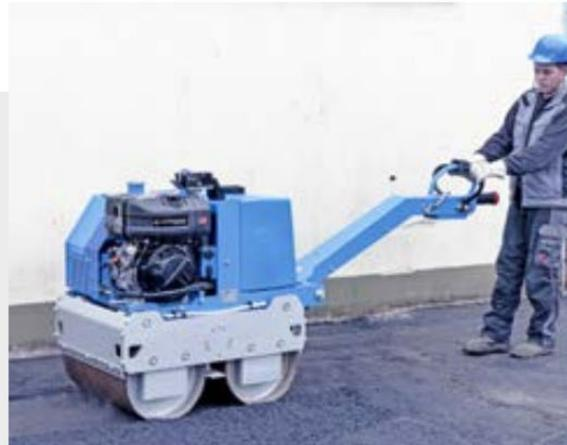
Hydrostatische Duplex-Walzen werden speziell für den Einsatz beim Bau von Geh-, Radwegen, Banketten und Parkplätzen entwickelt. In der Leistung, Langlebigkeit und Betriebssicherheit sowie im Arbeits- und Umweltschutz haben die DVH-Walzen Maßstäbe gesetzt.
