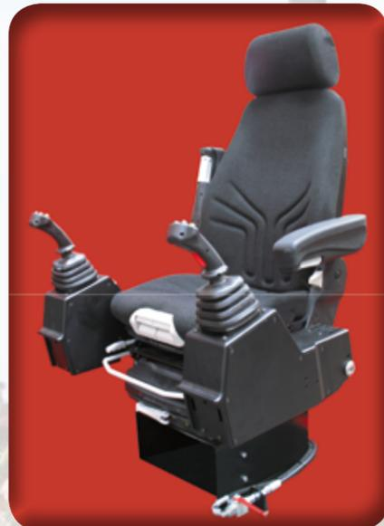
**Sedile di guida** molleggiato. 10 tipi di regolazioni, comandi ergonomici, braccioli regolabili, poggiatesta. Dotato di un dispositivo integrato di uomo presente per abilitare i comandi della macchina attivabile solo quando l'operatore è seduto al posto di guida e con il braccio abbassato. 2 rubinetti di emergenza per discesa cabina, di cui uno ai piedi del sedile ed uno raggiungibile da terra
