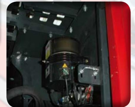
**Impianto di ingrassaggio** centralizzato automatico di serie per ralla e bracci.
