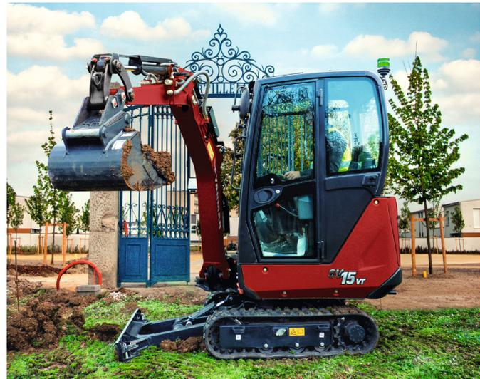
Der zuverlässige und leistungsstarke SV15vr verfügt über ein Hydrauliksystem mit Doppelzahnradpumpe mit 28 l/min und 205 bar maximalem Durchfluss und Druck. Die Maschine ist serienmäßig mit einem Zusatzhydraulikkreis für Hydraulikhämmer oder Erdbohrgeräte ausgestattet: Fördermenge 29 l/min, maximaler Druck 120 bar.
